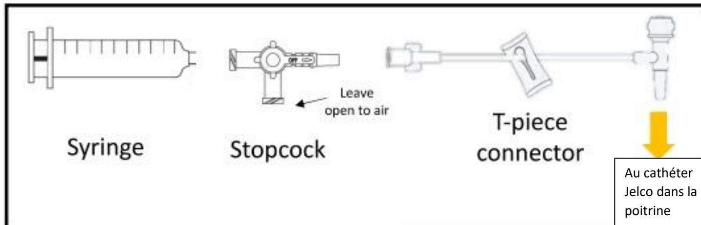
1. Assembler les matériaux ci-dessus avant la procédure : seringue > robinet 3-voies > connecteur en T
